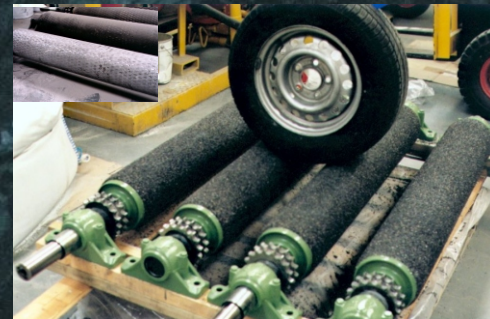
Rodillos de prueba de frenos reconstruïdos con Metal Tech F.G., Un metal sintético líquido. Ideal para reconstruir metal dañado de maquinaria y equipos
