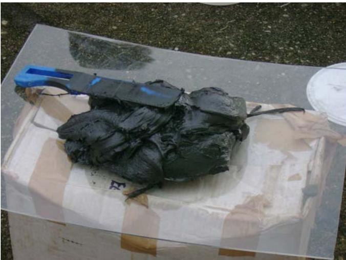
SE PROCEDE A LA PREPARACION DE LOS PRODUCTOS METALICOS MARCA THORTEX, GRADO PASTA, CON RESISTENCIA A LA COMPRESION, SUPERIOR A 210 KM/CM2.
