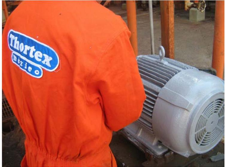
El recubrimiento CHEMI TECH 152 L.V. solo requiere de una preparación manual de la superficie. Preferentemente esta debe lavarse con agua a presión para desprender cualquier parte pobremente adherida y restos de recubrimientos anteriores. Alternativamente la superficie se puede limpiar completamente con cepillo de alambre.
